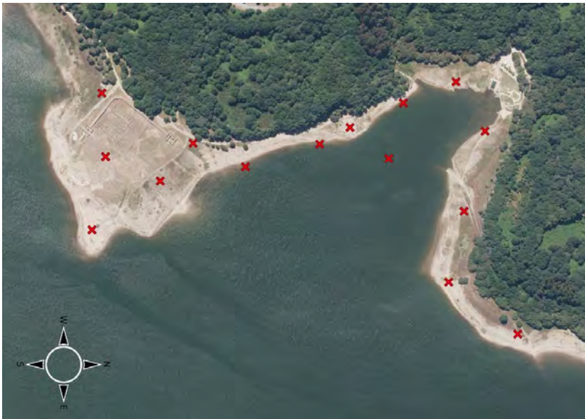
Figura 3. Localización dos puntos de control marcados sobre o terreo (PNOA cedido polo Instituto Xeográfico Nacional de España)
