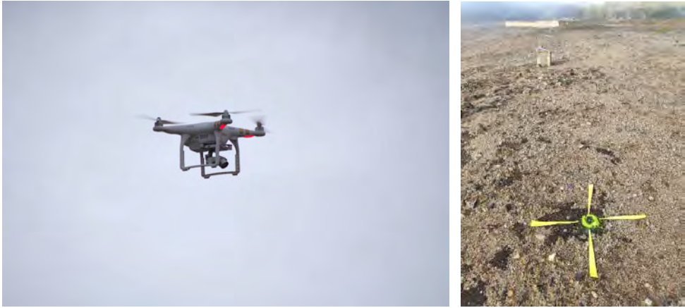
Figura 2. Á esquerda: imaxe do UAV empregado no presente traballo. Á dereita: demarcación dun punto de control sobre o terreo
